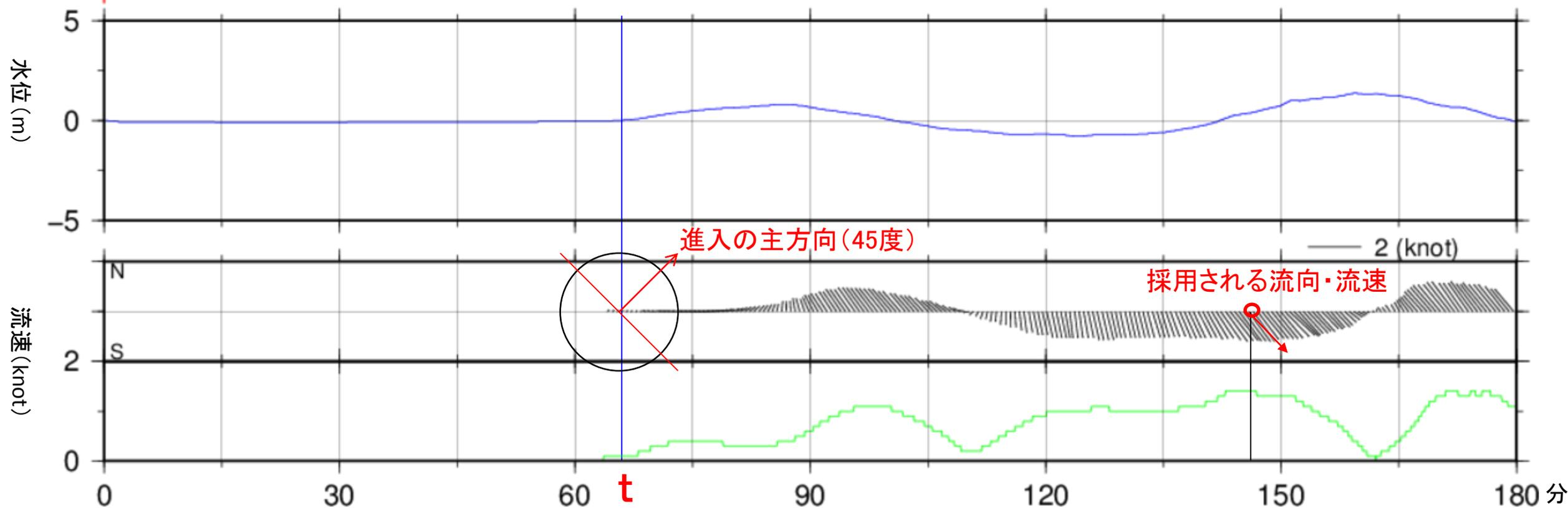
(津波防災情報図の進入方向と異なるように見えるが、時間  $t$  における進入の主方向(最初に水位上昇が10cmになった時点)は45度であり、採用される進入方向は45度±90度の範囲の最大流となるので、津波防災情報図と合致している)
