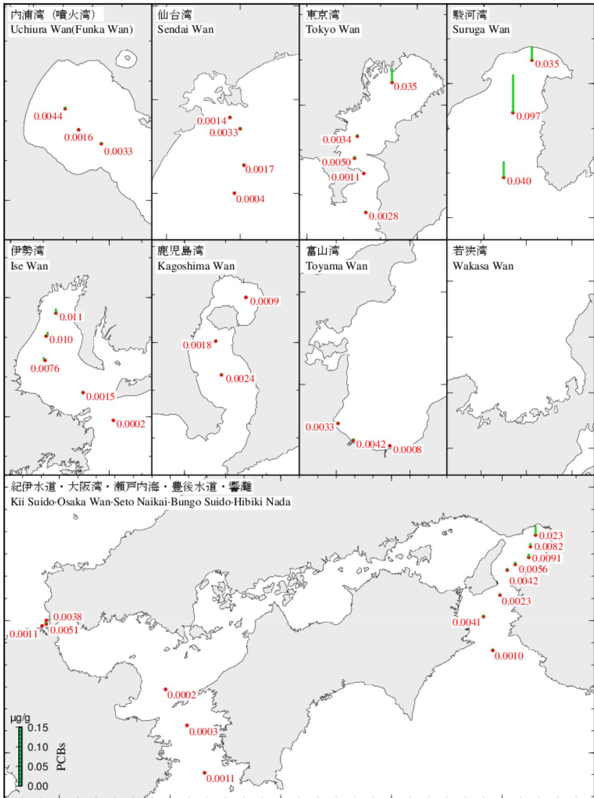
図4 海底堆積物中の PCB 濃度(µg/g)
