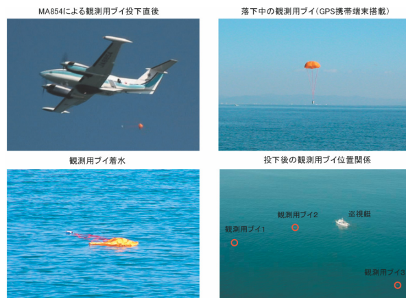
第6図 航空機による観測用ブイ投下実験 Fig. 6 Experiment to buoy drop in sea area from the patrol craft
