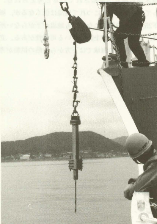
写真2 測量船「天洋」の前甲板での浅海底地熱測定装置の投入揚収作業
