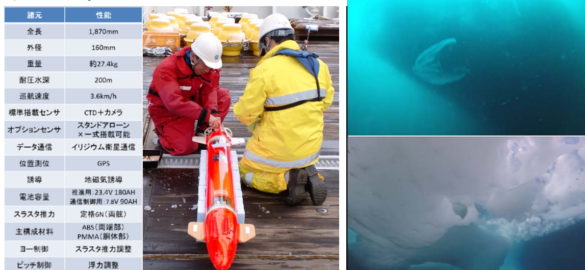
図 1. 海氷下観測用小型 AUV の諸元、実機写真と海氷下および生物画像
