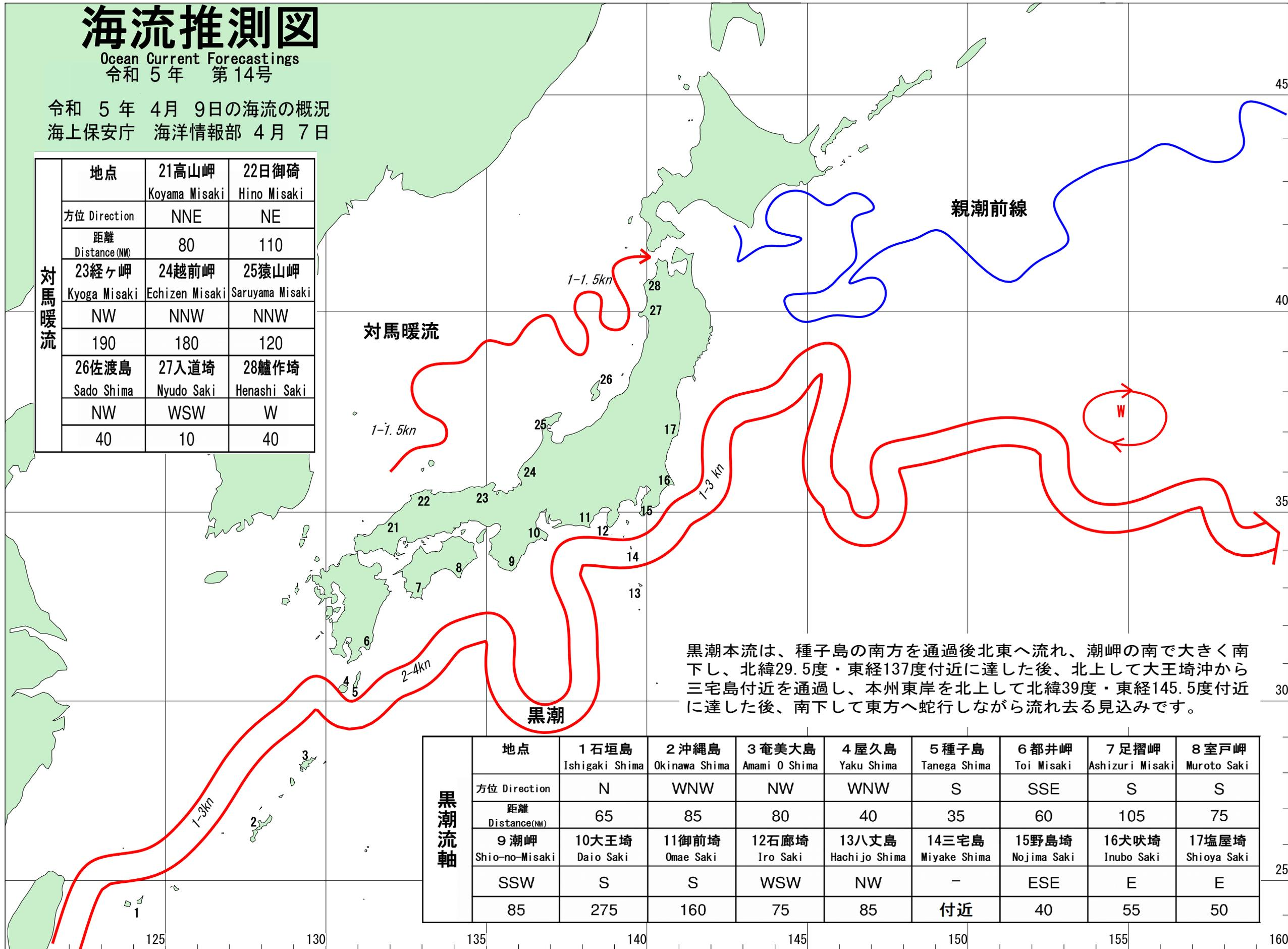
黒潮本流は、種子島の南方を通過後北東へ流れ、潮岬の南で大きく南下し、北緯29.5度・東経137度付近に達した後、北上して大王埼沖から三宅島付近を通過し、本州東岸を北上して北緯39度・東経145.5度付近に達した後、南下して東方へ蛇行しながら流れ去る見込みです。
