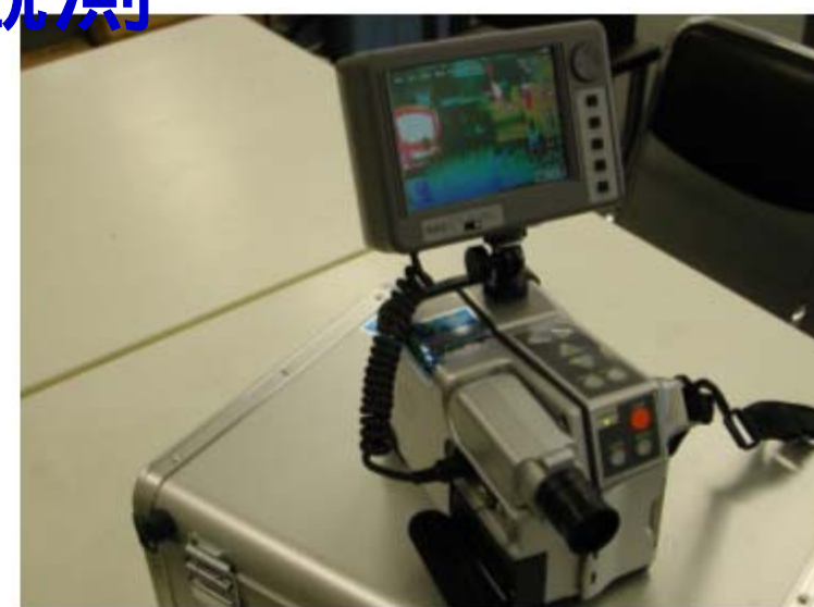
図 2.3.7 赤外線ビデオカメラ(NEC 三栄(株)TH7100)
