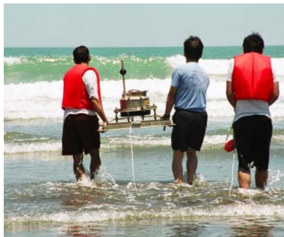
波高計・流速計の設置作業
