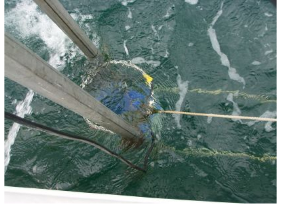
可搬型ADCP設置状況
