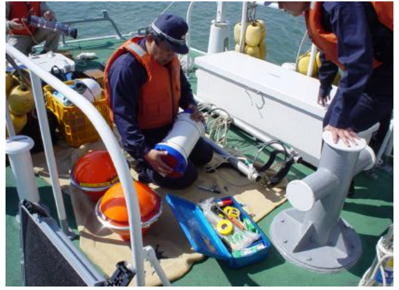
可搬型ADCP設置作業
