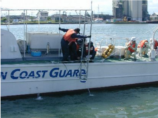
可搬型ADCP設置作業
