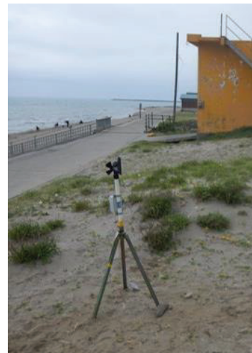
写真5 風向風速計の設置状況
