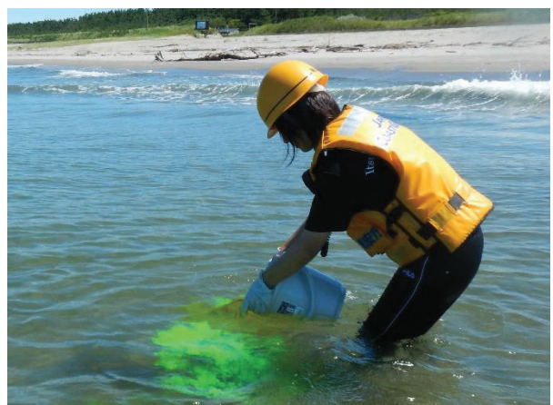
写真2 着色剤の散布状況
