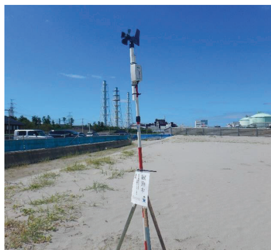
写真4 風向風速計の設置状況
