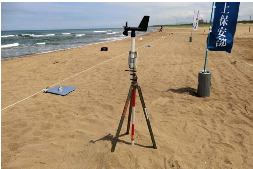
写真5 風向風速計の設置状況
