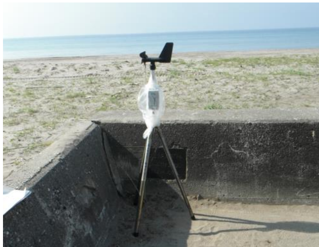
写真5 風向風速計の設置状況
