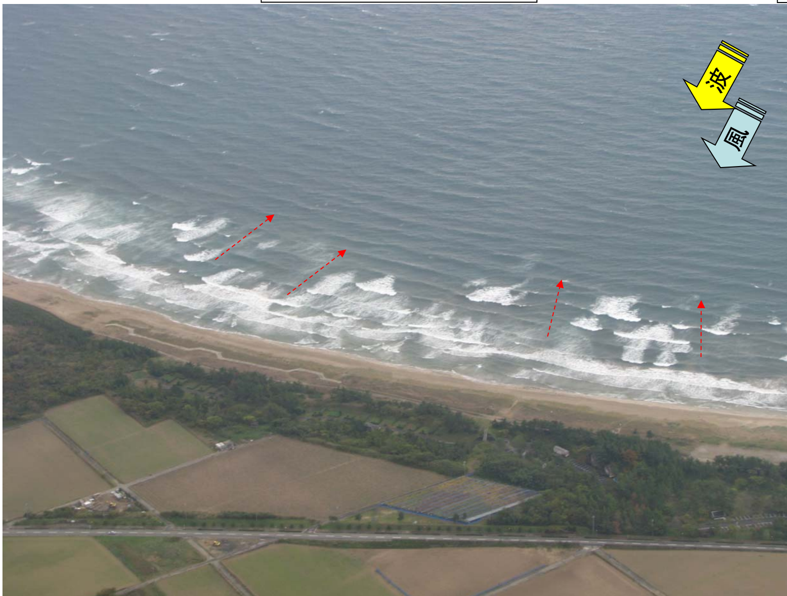
波の切れ間(赤破線)からの離岸流が確認された。 調査時の風は、西南西(写真右上側からの風)約7m/sで、波も同じ方向からだった。
