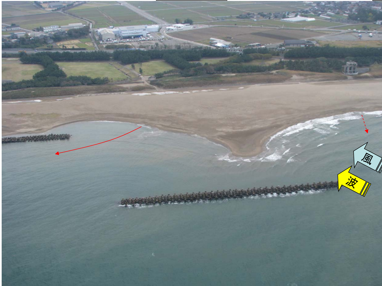
砂が流れ出る様子(赤色実線)や、波の切れ間(赤破線)からの離岸流が確認された。海岸線の凹凸が大きく、離岸堤もあることから、離岸流が発生しやすい地形的条件だった。 調査時の風は、南南西(写真右下側からの風)約4m/sで、波も同じ方向からだった。
