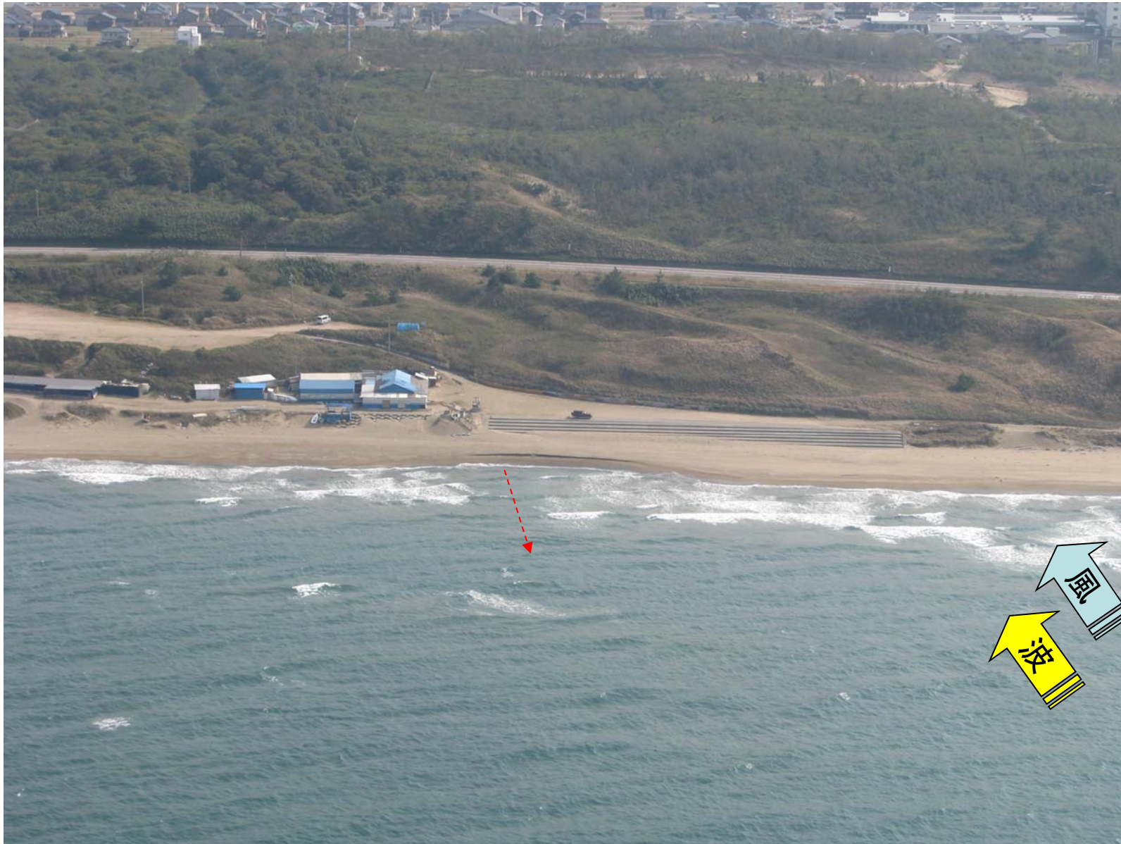
砂が流れ出る様子(赤色実線)や、波の切れ間(赤破線)からの離岸流が確認された。調査時の風は、南西(写真右下側からの風)約5m/sで、波も同じ方向からだった。
