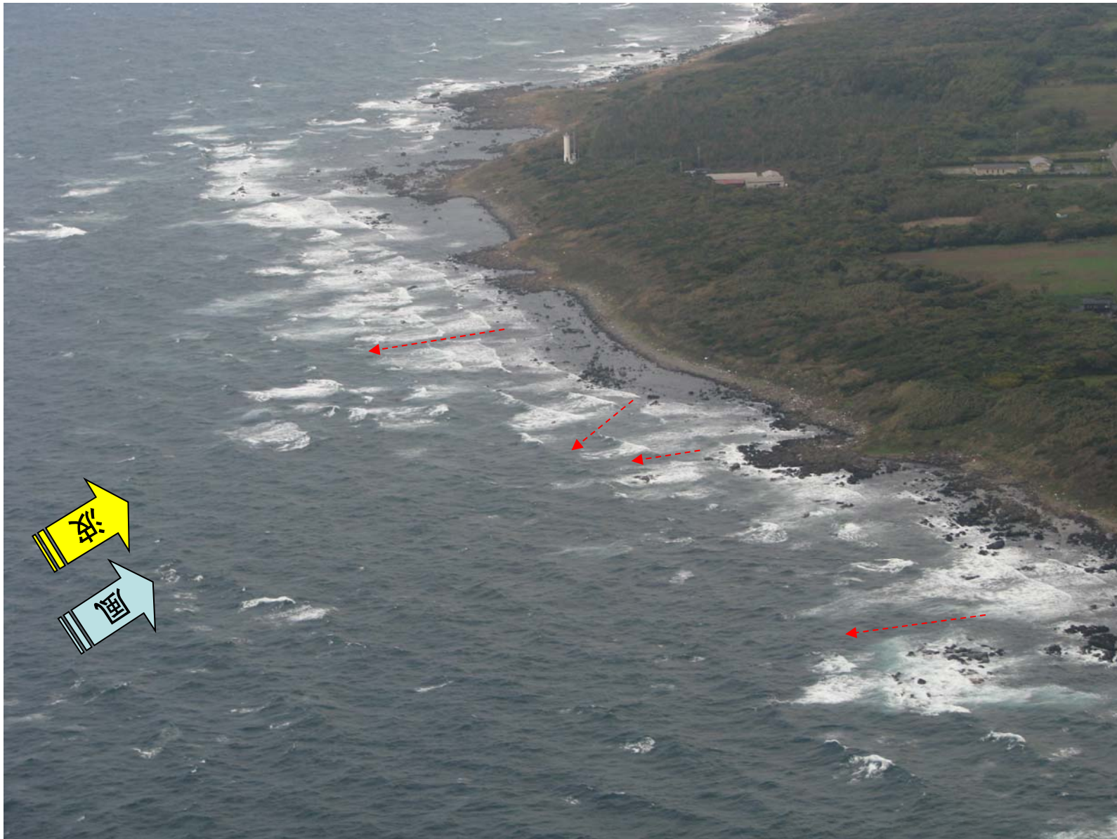
波の切れ間(赤破線)からの離岸流が確認された。この海岸は岩場で、離岸流が岩を避けるように流れ出ていた。調査時の風は、西南西(写真右上側からの風)約7m/sで、波も同じ方向からだった。
