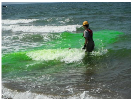
写真3 (着色剤の散布状況)
