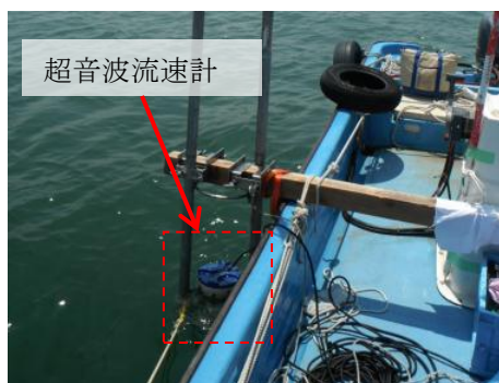
写真5 (超音波流速計機装状況)
