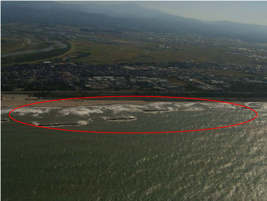
多数の離岸堤の間で海水の出入りがあり、複雑な流れが発生。
