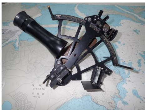
六分儀：物標や天体の角度・高度を測定する計器
