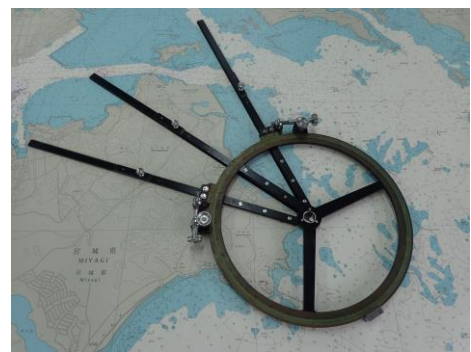
三稜分度器：六分儀で測定した角度を海図に記入する際に使用する器具
