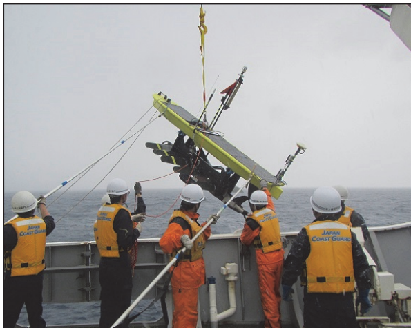
図5 AOV投入状況
